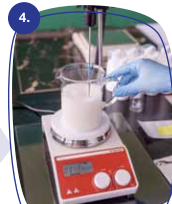
4. Miešame na magnetickej miešačke pri teplote do 40°C
