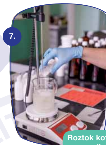
4. Miešame na magnetickej miešačke pri teplote do 40°C
